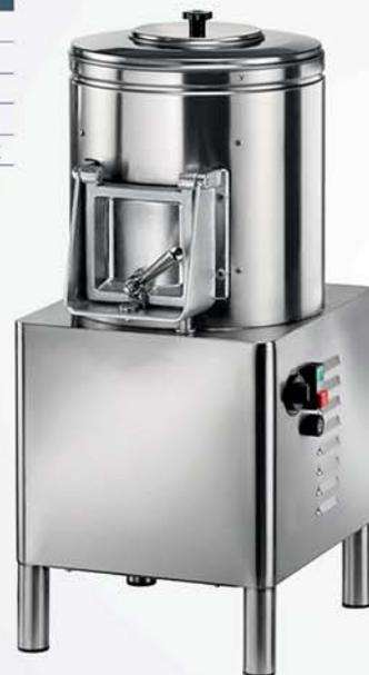
Máquina en columna, construida en acero inoxidable. Su interior está revestido de un material abrasivo resistente al desgaste y de fácil mantenimiento que asegura, en todo momento, la producción. Dispone de un microinterruptor de tipo mecánico que permite el funcionamiento de la máquina solamente cuando la puerta está cerrada. La central de mandos funciona a 24 voltios.
