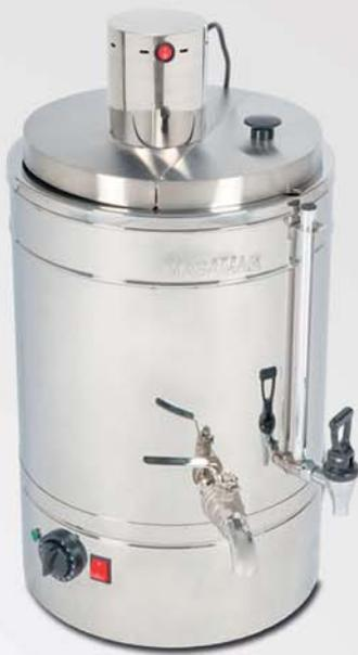
Chocolatera eléctrica construida en acero inoxidable con nivel de agua y agitador de palas eléctrico. Cuba en acero inoxidable fácilmente desmontable. Hace y mantiene el chocolate al baño maría. Termostato regulable: 0°C a 120°C.
